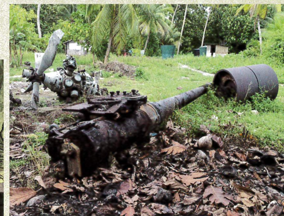
(上) 艦載砲を沿岸防備に転用した15cm砲の砲身と二式大艇のエンジン。飛行艇棧橋付近に無造作に置かれている。(左) 空襲で崩れた発電所の内部。発電機が残っている。島内には発電所が3か所あり、ここが一番大きい。
