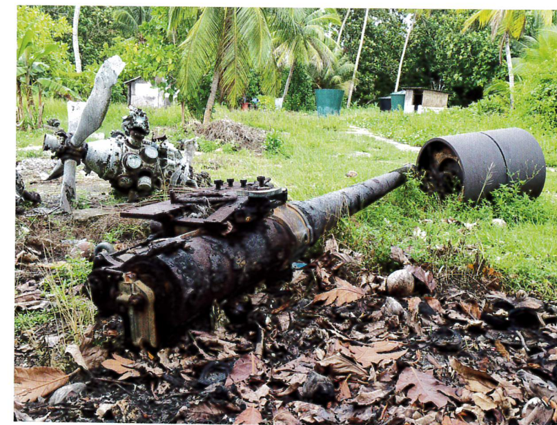
大砲と航空機の発動機が無造作に放置されている。奥にあるのは二式大艇のプロペラと火星型発動機と思われる。
